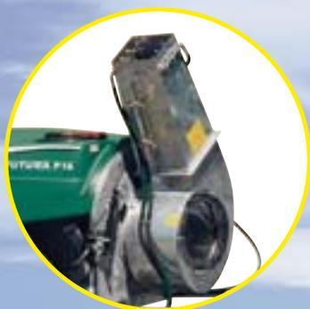
**I** Ad integrazione della grande offerta di ventilatori assiali montati sulla gamma Futura, Unigreen propone i modelli dotati di girante centrifuga con frizione ad espansione con diffusore a Cannone (equipaggiabili con teste erogatrici fisse o snodate) o Bichiocciola.
