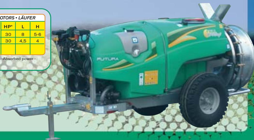
**I** La modularità del progetto FUTURA è resa ancora più evidente dal posizionamento sulla cisterna principale di una quarta cisterna per la pre-miscelazione del prodotto, agevolando la diluizione nella cisterna principale del prodotto chimico. Il Pre-miscelatore viene reinserito dopo l'uso nella sagoma della cisterna principale, mantenendo inalterato l'ingombro della macchina.
