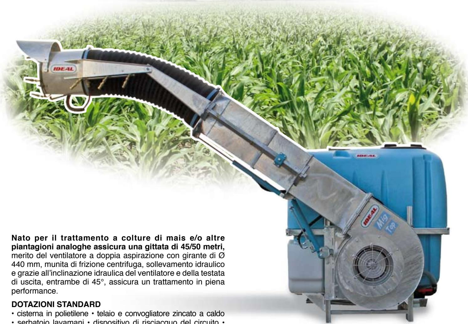
**Nato per il trattamento a colture di mais e/o altre piantagioni analoghe assicura una gittata di 45/50 metri, merito del ventilatore a doppia aspirazione con girante di Ø 440 mm, munita di frizione centrifuga, sollevamento idraulico e grazie all'inclinazione idraulica del ventilatore e della testata di uscita, entrambe di 45°, assicura un trattamento in piena performance.**
