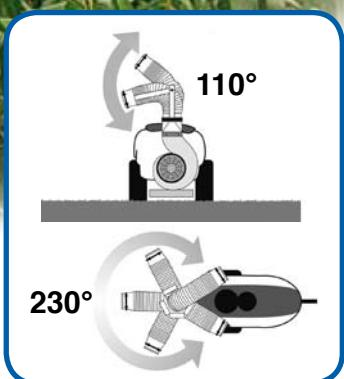
Atomizzatore con cannone omnidirezionale. La macchina grazie all'ottima portata d'aria, alla rotazione idraulica della testata di uscita di 230° ed all'inclinazione della stessa di 110° è adatta al trattamento di piante d'alto fusto e al trattamento di colture a campo aperto. La movimentazione della bocca di uscita come l'apertura e la chiusura dell'acqua sono comandati direttamente dall'operatore dal posto di guida.
