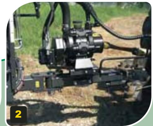
Il campo 'C' con sollevamento verticale ammortizzato porta barre da 18 a 21mt con e senza manica d'aria, per utilizzi su terreni particolarmente sconnessi è possibile integrare lo sollevamento con una sospensione ammortizzata supplementare (2 M)
