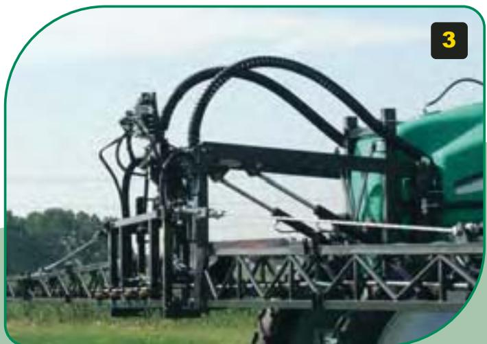
Il Campo S è un prodotto al top della categoria, progettato per usi professionali. L'assale, il sollevamento a parallelogramma (1600mm) e la barra sono completamente ammortizzati con pistoni ed accumulatori idropneumatici ad azoto. Questo equipaggiamento migliora la stabilità della barra e diminuisce le sollecitazioni sia durante il lavoro che durante il trasporto, rendendo il CAMPO S adatto a lunghi trasferimenti su asfalto o serrato.
