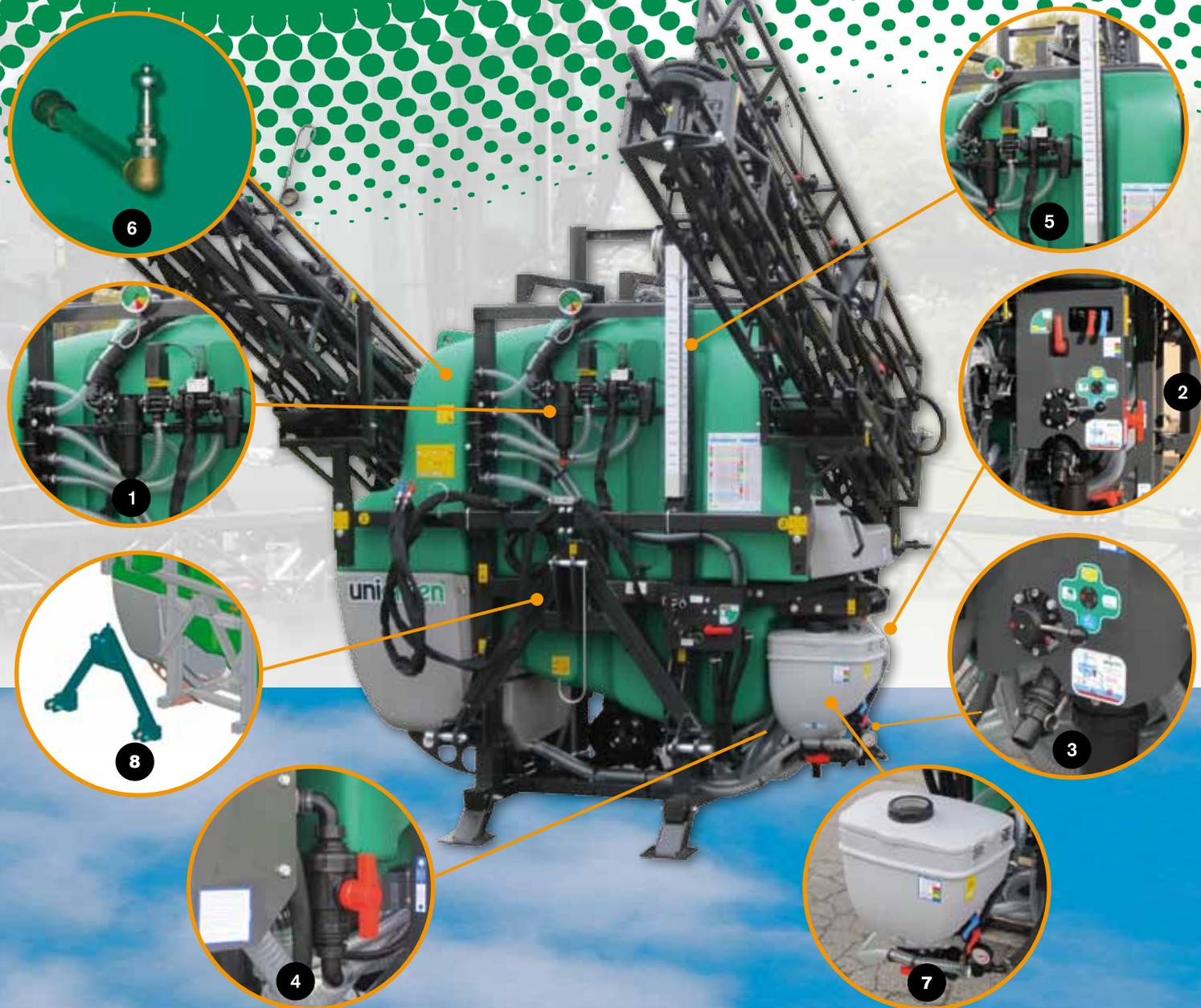
Cisterne da 1300 a 1900 litri in polietilene molto compatte contengono il peso a sbalzo posteriore e sono dotate di agitazione idraulica tramite tubo forato e di livello a secco (5).
